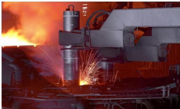
图 3-2.1 炼钢炉电极
