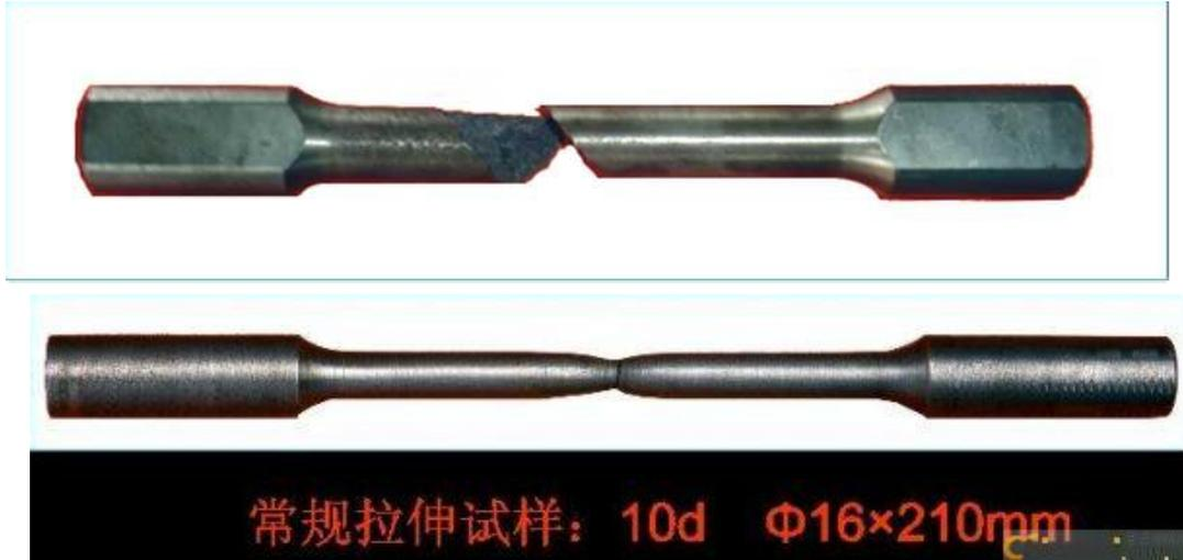
图 2.5 样品拉伸试验
