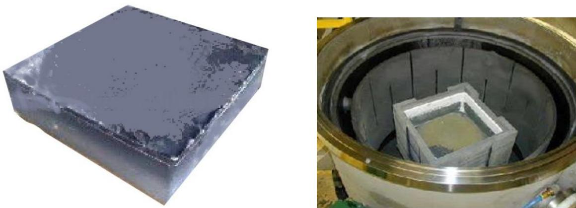
图 2.13 多晶硅锭及其定向凝固生长
