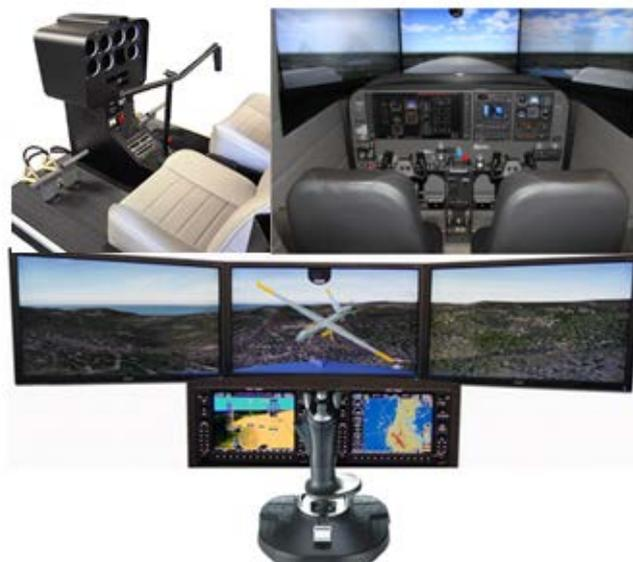
CNFS 飞行模拟器系统结合 AGDMS 飞行器总体设计与仿真平台，使用飞机设计、仿真软件计算所得的飞机性能与控制参数输入到飞行仿真软件系统中，可以模拟所设计飞机的飞行动力学、导航、控制等状态，所获取的工程参数将由 CNRAS 飞机总体参数采集分析软件分析处理，用于飞机性能评价、飞行员培训训练以及其它科研教学任务。
