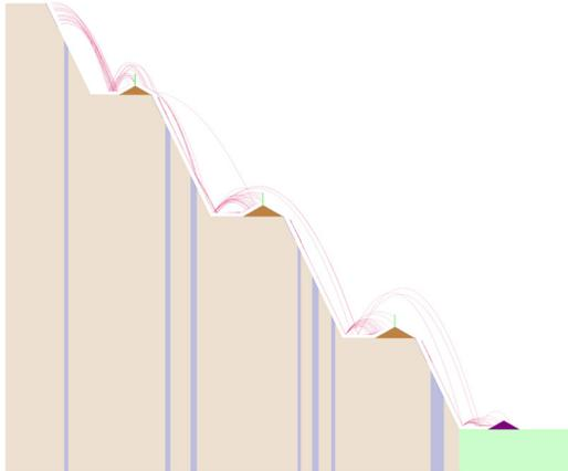
土坡上的护堤和对应的落石路径结果
