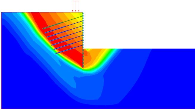
板桩墙抗剪强度降低引起的总位移等值线结果
