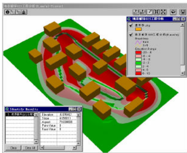
图5 开采沉陷GIS专题工程分析图
