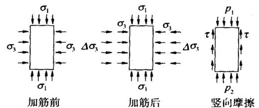
图 1 土工格室加筋的侧向约束力效应
