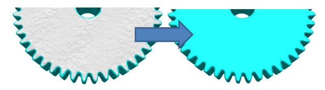
**移除:** 移除选中的单元。工具同时中提供了填补的选项,来自动对移除的部分进行填补。这一工具可以用来手动清除面对象上不需要的特征、对单元进行修复或优化、以及创建非封闭面对象。
