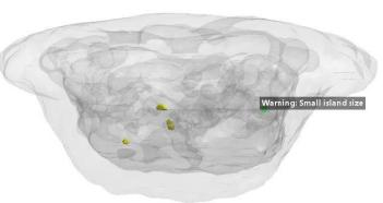
软件使用的网格算法能够保证完全根据我们分割的模型来生成网格,分割模型的质量会直接影响到生成网格的质量。新版本中的模型质量检查工具允许我们在网格划分前对任意类型的模型进行
