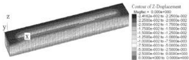
图5 基坑附近沉降等值线
