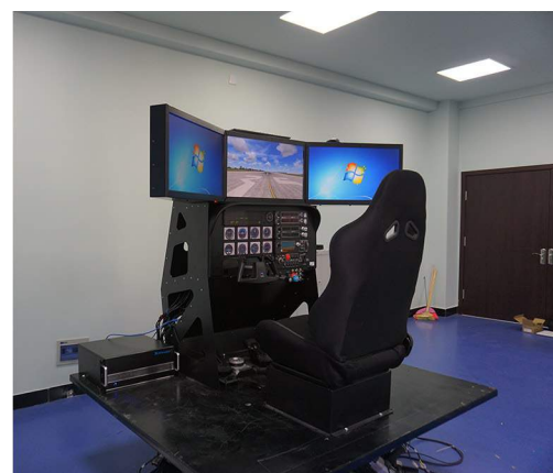
AATD/BITD桌面式飞行训练器 按照FAR/CCAR2级标准设计制造
