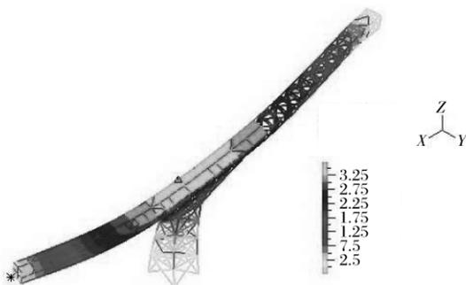
图 7 最大位移 mm
