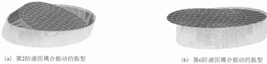
图 4  $15 \times 10^4 \text{ m}^3$  储罐第 2,6 阶液固耦合振动振型
