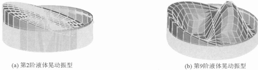
图 5  $15 \times 10^4 \text{ m}^3$  储罐第 2,9 阶液体晃动振型
