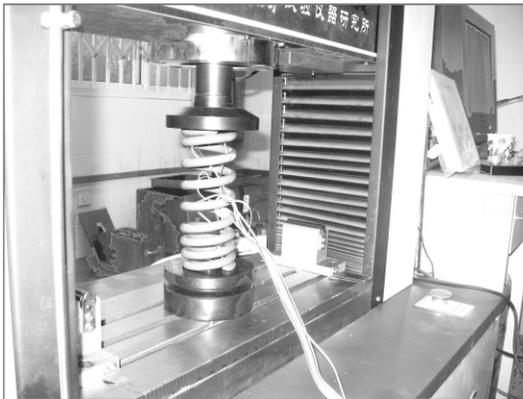
图 4 2172 弹簧应力测试施加载荷
