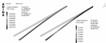
图 3 固结时流场速度为  $1.7 \text{ m/s}$  时  $X$  和  $Y$  方向的偏移
