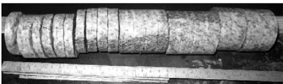
图 2 极高地应力造成强烈的岩芯饼化现象
