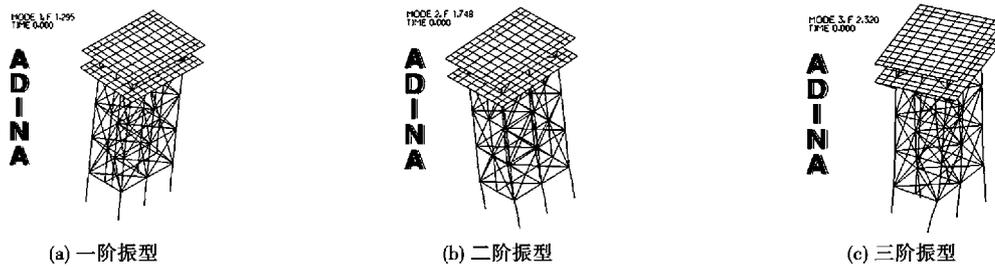
图3 耦合工况下海洋平台前三阶振型
