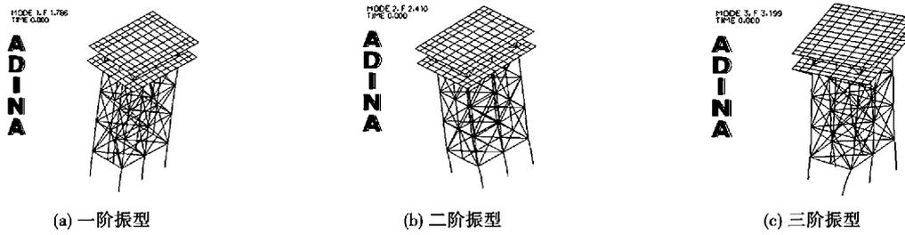
图2 非耦合工况下海洋平台前三阶振型
