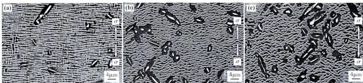
图 3 DD10 合金 1100℃/140MPa 持久断裂后不同部位(100) 截面显微组织 (a) 夹头; (b) 远离断口; (c) 断口附近
