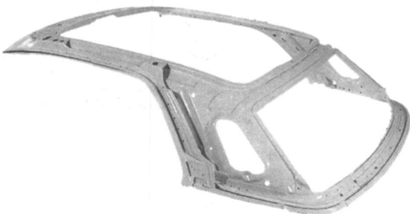
图 13 BMW3 系列车顶(125 个压力连接点)
