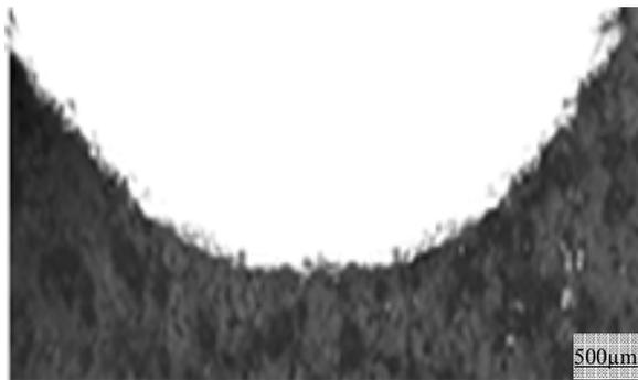
图4 实际熔池形貌
