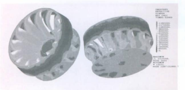
图 1 固体部分应力分布 (单位: Pa)
