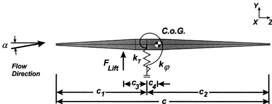
Fig. 2. Supersonic fin profile (2D-model).
