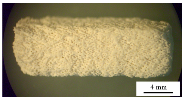
图 1 多孔的珊瑚羟基磷灰石骨修复材料
